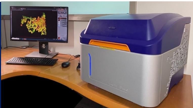
スピニングディスク共焦点システムをベースとしたBOXタイプの卓上共焦点顕微鏡です。共焦点、Widefield蛍光、透過光(明視野と微分位相差コントラスト)に、対応しております。
